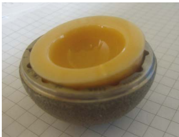
Obr. 2.18 Nesprávně vložená keramická vložka do kovové jamky Plasma cup SC (snímek pořídil Todd Stewart, Leeds, UK)
