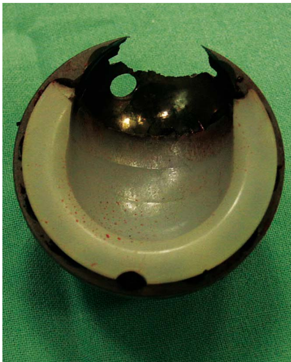
Obr. 2.15 Úplné prošlapání polyethylenu a skoro celé tloušťky kovové části jamky ABG I
